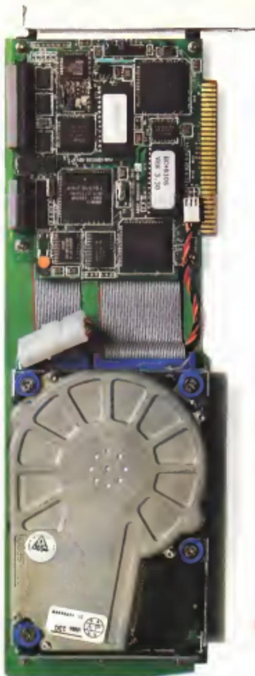
HARDCARDplus è un disco rigido da 33-51-66 MB, integrato su scheda con gli elementi di controllo, che trasforma il vostro PC in un XT.
